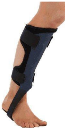
Ábra: Toe off szénszál-as műanyagból kevlár erősítéssel készülő dinamikus ortézis. Mozgó alkatrészt nem tartalmaz. Lépéskor anyagában deformálódik, az átgördüléskor a tárolt erő visszapotlódik.
